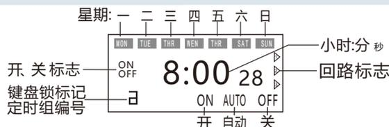
显示屏左下角有一个“ $\square$ ”符号，表示此时键盘处于锁定状态，时控开关不接受键盘上的一般性操作。连按四下“取消/恢复”键，“ $\square$ ”符号消失，此时键盘处于开锁状态，可接受操作指令。（注意，键盘30秒内无操作，时控开关将自动恢复锁定状态。）
