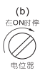
B 在无检测物体状态下把电位器慢慢向右旋转在接近开关ON位置时停下
